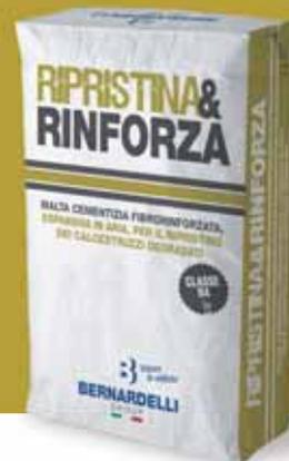
**RIPRISTINA&RINFORZA** è una malta cementizia tixotropica monocomponente, fibrorinforzata, espansiva in aria, di classe R4 secondo la normativa EN 1504-3, a presa normale, per il rinforzo di strutture in calcestruzzo armato.
