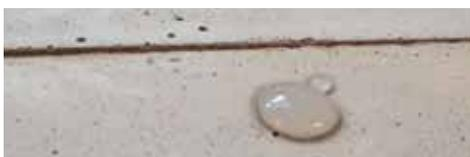
Il bassissimo assorbimento d'acqua proveniente sia da pioggia battente che da risalita capillare limita notevolmente la propagazione delle efflorescenze saline.
